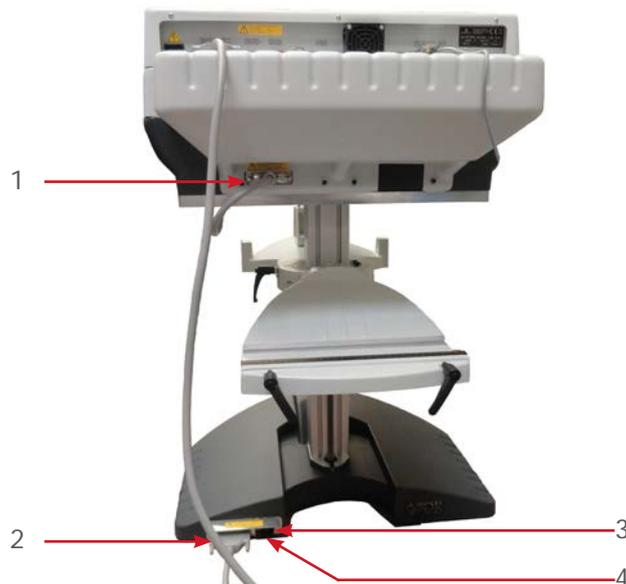
1. Verbindung: Basis VOLUME / Maschine - **Spannung SELV**
