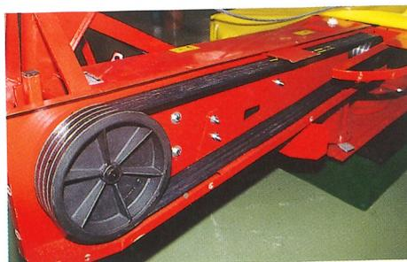
Keilriemenantrieb (Abb. ohne Schutzvorrichtung)
